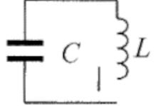
$\begin{cases} q(t) = q_{\max} \sin(\omega t + \phi_0) \\ I(t) = \dot{q} = \omega q_{\max} \cos(\omega t + \phi_0) = I_{\max} \cos(\omega t - \phi_0) \end{cases}$ $\text{Формула Томсона: } T = 2\pi \sqrt{LC}, \text{ откуда } \omega = \frac{2\pi}{T} = \frac{1}{\sqrt{LC}}.$ |
